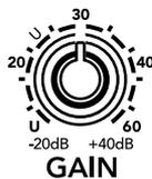
Der 6,35 mm-Klinkeneingang bietet 20 dB Bedämpfung bei ganz zurückgedrehtem Regler und 40 dB Verstärkung bei ganz aufgedrehtem Regler, mit der "U"-Markierung (Unity Gain) bei 10:00 Uhr. Diese 20 dB Bedämpfung kann sehr praktisch sein, wenn Sie ein sehr lautes Signal einspeisen oder viel EQ-Verstärkung hinzufügen möchten oder beides. Ohne dieses "virtuelle Pad" könnte der Kanal übersteuert werden.
